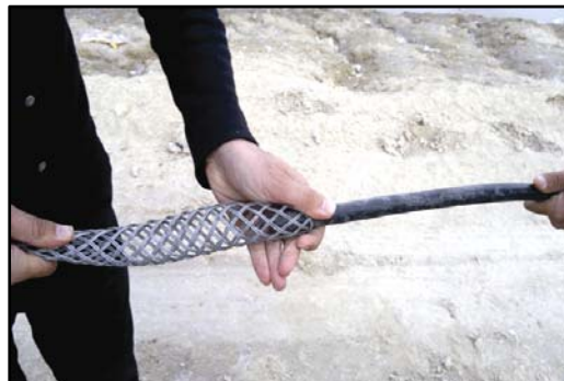
الف- نحوه قرار گرفتن جوراب بر روی هادی
